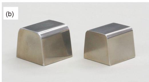
元素名：Scandium，原子番号：21，原子量：44.96，電子配置：[Ar] 3d<sup>1</sup> 4s<sup>2</sup>，密度：2.992 Mg·m<sup>-3</sup>(293 K)，結晶構造：六方最密(～1607 K)，体心立方(1607～1810 K)，融点：1810 K，沸点：3105 K<sup>(1)</sup>，地殻存在量：21.9 μg·g<sup>-1</sup><sup>(2)</sup>【写真】(a)酸化スカンジウム，(b)Al-Sc 母合金(いずれも資料提供：住友金属鉱山株式会社)。
